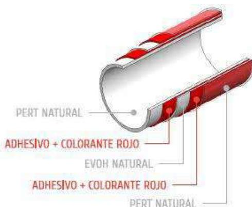
Las tuberías PERT EVOH de 5 capas tipo II, se pueden utilizar para la distribución de agua en sistemas de calefacción y/o refrigeración. Gracias a la gran flexibilidad de este material, las operaciones de colocación de los tubos resultan extremadamente sencillas, ya que no está sujeta a incrustaciones y fenómenos electroquímicos. Las tuberías PERT EVOH de 5 capas están extruidas con una barrera antioxígeno EVOH fabricada según ISO 22391 - DIN 4726 e ISO 17455.
