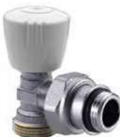
Las válvulas manuales se utilizan para interceptar el flujo de fluido al cuerpo de calentamiento. El ajuste se puede hacer girando la perilla en sentido horario para disminuir el flujo, o en sentido antihorario para aumentarlo.
